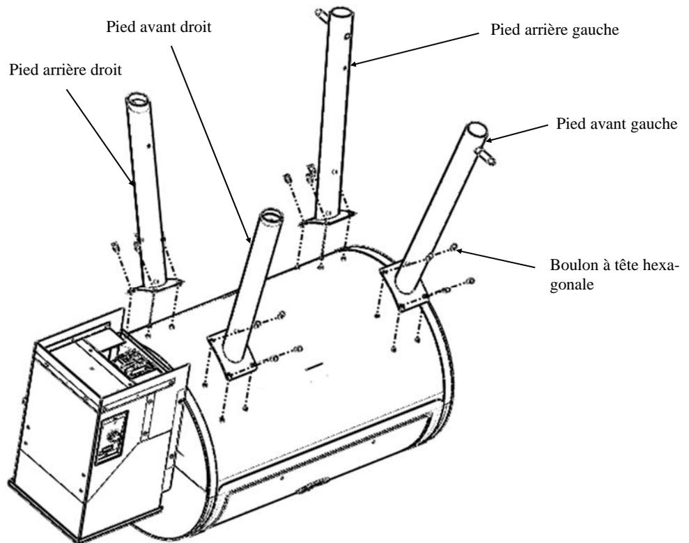
Étape 2 : Placez le plateau inférieur entre les (4) pieds en vous assurant que les trous situés sur le plateau inférieur et sur les jambes soient alignés puis serrez avec (4) boulons à tête hexagonale.
