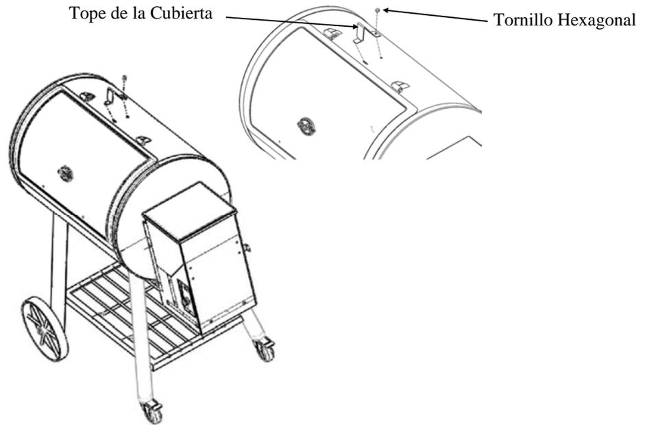
Paso 6: Coloque los embellecedores de manejar en cada extremo de la manija, colocarlos en la tapa de la parrilla luego apriételos con (2) pernos hexagonales, véase abajo.
