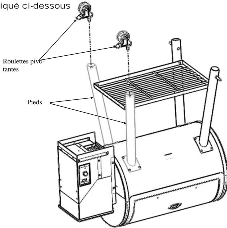
Étape 4 : Placez les roues en métal et les rondelles plates sur les axes situés sur les pieds et serrez-les à l'aide des écrous hexagonaux de 7/16"-20.
