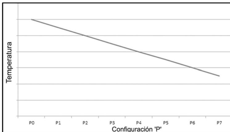
Aumentar el valor 'P' disminuye la velocidad de alimentación de combustible, lo que produce un descenso en la temperatura del Asador. Ajuste la configuración 'P' para la temperatura deseada o la producción de humo. **Para una cocción sin problemas, P2 es la configuración recomendada.**
