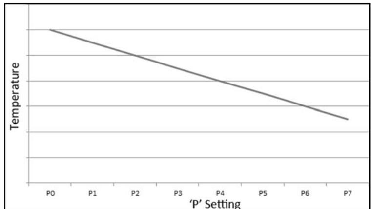
L'augmentation de la valeur 'P' diminue le débit d'injection des granulés, ce qui entraîne la diminution de la température du gril. Ajustez le paramètre 'P' à la température et/ou à la production de fumée souhaitée(s). **Pour une cuisson sans souci, P2 est le réglage recommandé.**
